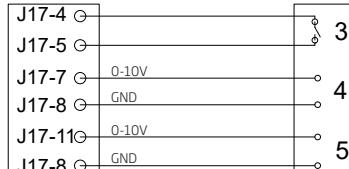
A-BMS legger 13,5 VDC utgangssignalet via en NO-kontakt (NO) (3) fra klemme J17-4 på klemme J17-5 (AI#1). Dermed startes og stoppes ventilasjonsanlegget i henhold til A-BMS programmering.
