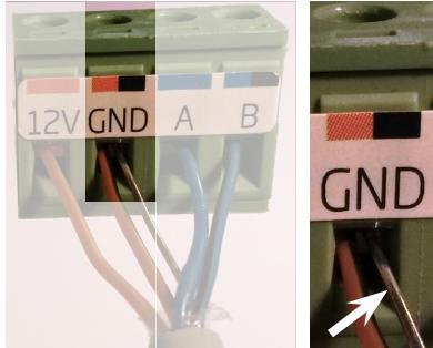
Avslutt skjermen til både betjeningspanelet og sensorene ved styreboksen i ventilasjonsanlegget etter følgende anvisninger.
