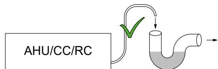
Vi anbefaler at det monteres en vannlås på avløpssystemet for å unngå dårlig lukt fra avløpssystemet.
